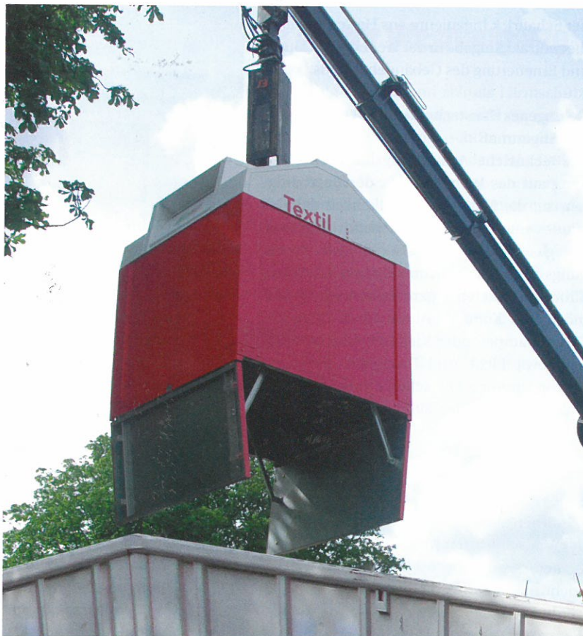
Entleerung über Bodenklappen mittels Kran
